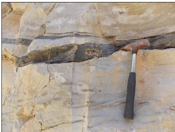
Figura 39 - Vista em detalhe das rochas areníticas finas a muito finas com intercalações de rochas argilosas da Formação Rio Bonito.
